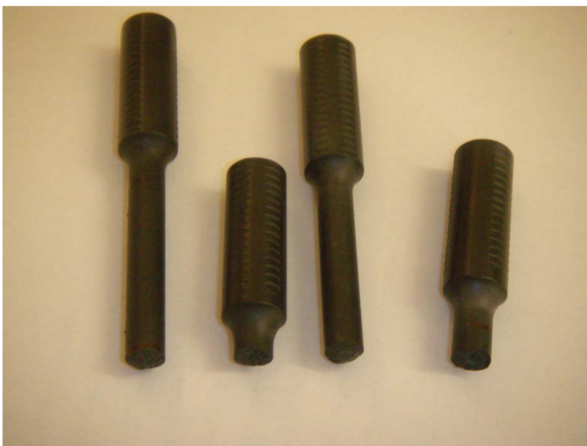
Figura 5.4: Immagine del cedimento occorso ai provini sottoposti al test di resistenza a trazione
