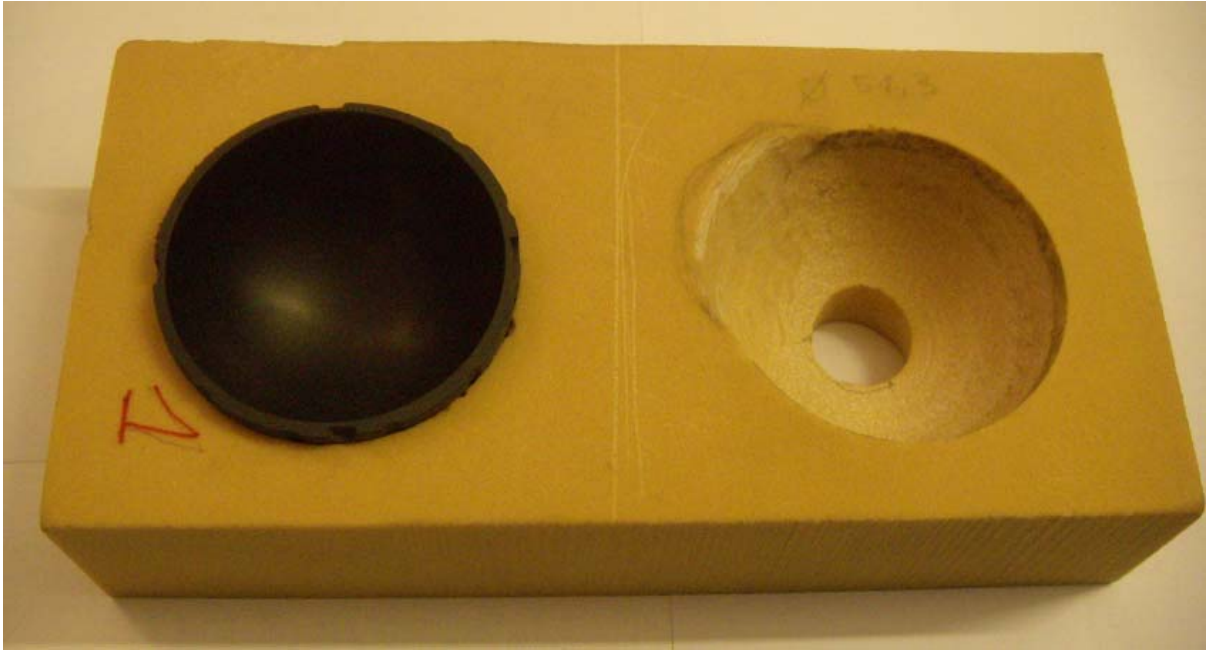
Figura 8.2: Blocco in poliuretano con cavità di forma leggermente ovalizzata utilizzato per la prova di deformazione
