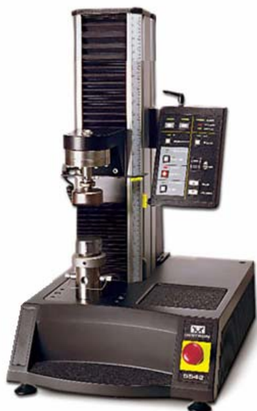
Figura 5.3: Esempio di macchina per l'attuazione della prova di trazione
