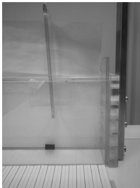
Figura 2.9 Sollevamento della parete che dà inizio all'esperimento.
