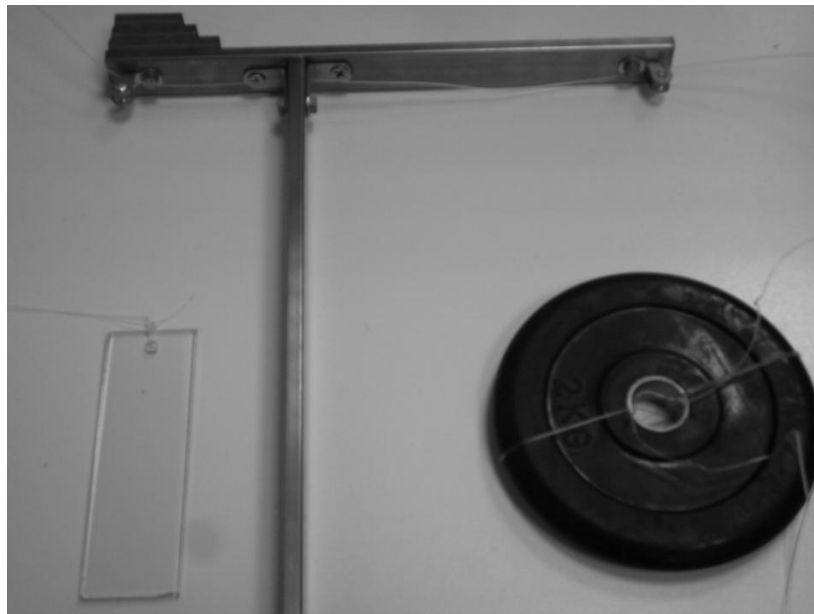
Figura 2.8 Sistema di alzata per la parete frontale.
