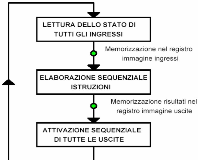
Fig. 1.4.2 diagramma a blocchi del ciclo operativo del plc (da automation.siemens.com)
