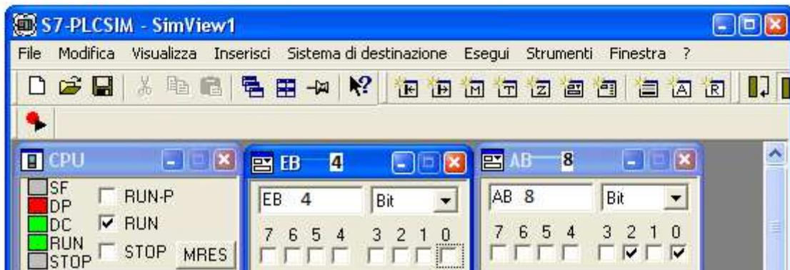
In questo caso il simulatore presenta attive le uscite 0=teleruttore marcia avanti e 2=lampeggio; questa è la fase di transizione in cui le fasi sono aperte e il motore gira per inerzia. Infatti i segmenti 12 e 13 non sono verdi a linea continua.
