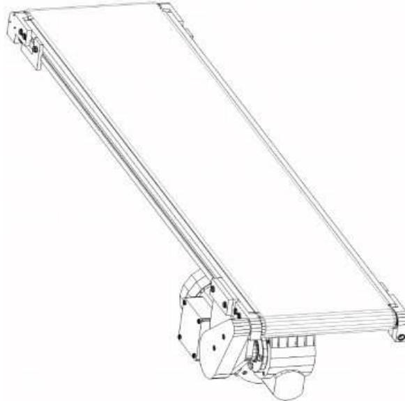
fig. 3.2.1 nastro trasportatore (da Gottardo)
