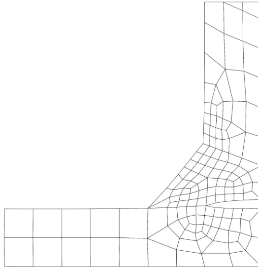
Fig. 6BIS.2 - Refinement del piede cordone di saldatura e zona cricca, condizione deformata
