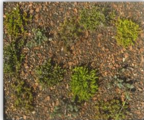
Figura 78 Rilievo fotografico su una tesi con Sedum, substrato con laterizio e strato di accumulo e drenaggio perlite
