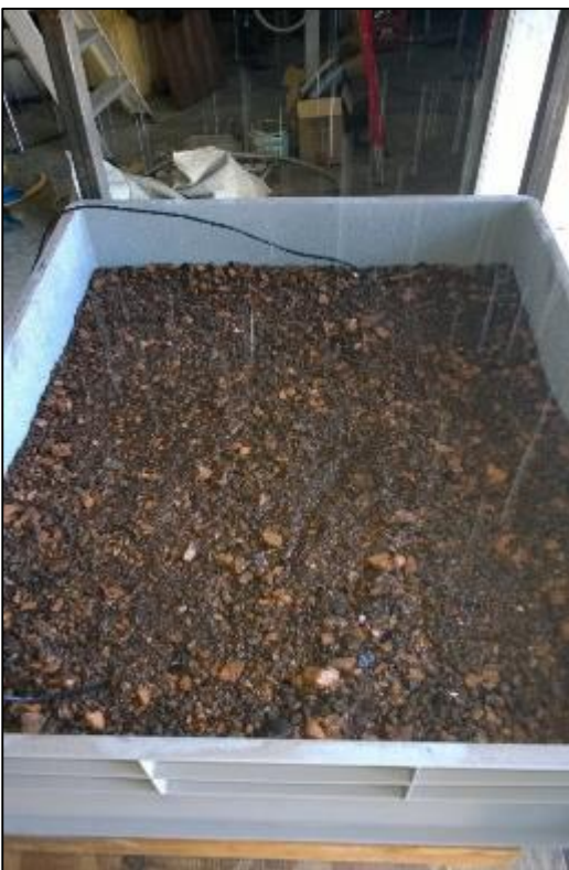
Figura 75 Terreno ZinCO con sonde di temperatura e umidità durante la prova con il simulatore di pioggia
