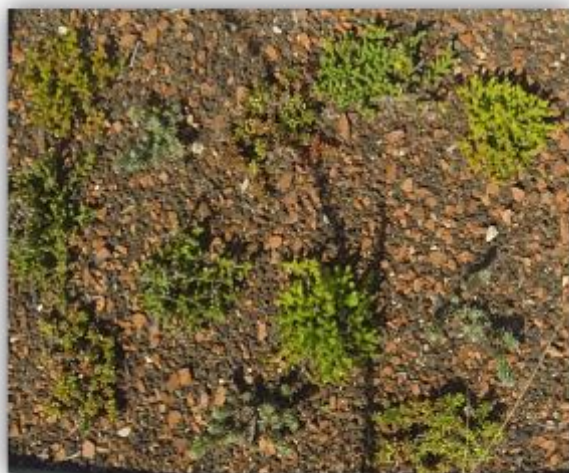
Figura 78 Rilievo fotografico su una tesi con Sedum, substrato con laterizio e strato di accumulo e drenaggio perlite
