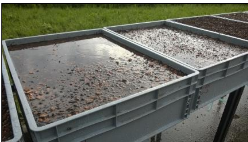
Figura 77 Difficoltà di infiltrazione dell'acqua nel substrato ZinCo a differenza del substrato dell'Europomice in seguito ad un evento di
