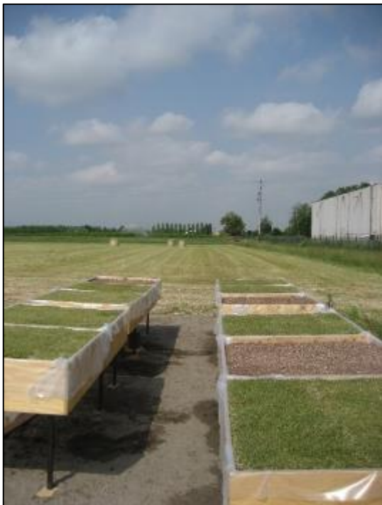
Figura 27 Cassoni prova tetto verde intensivo leggero presso l'azienda sperimentale ad Agripolis
