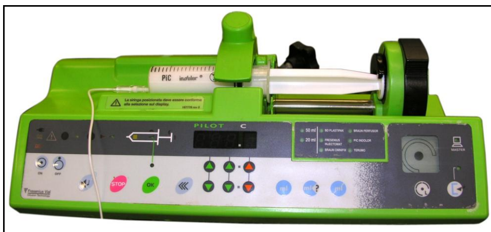
Figura 1.1 Esempio di pompa-siringa utilizzata per l'infusione continua di farmaci (Fresenius, Pilotec, Italia).
