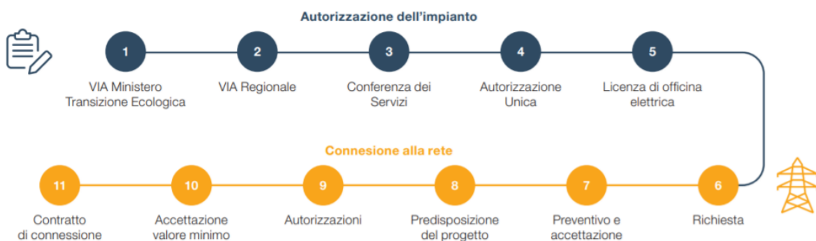
Figura 6 - Iter per la messa in opera di un impianto APV (Fonte: Legambiente)
