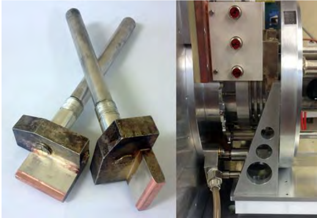
Figura 3.15: particolare delle lavorazioni eseguite nei puntali elettrici (sinistra) e dell'innesco dell'apparato sperimentale nel sistema portante (destra)
