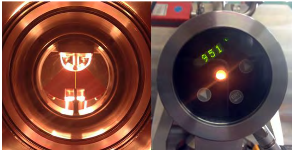
Figura 3.24: particolare della zona scansionata dal pirometro per le misure di temperatura (percorso evidenziato in giallo a sinistra) e il pirometro in funzione (a destra)
