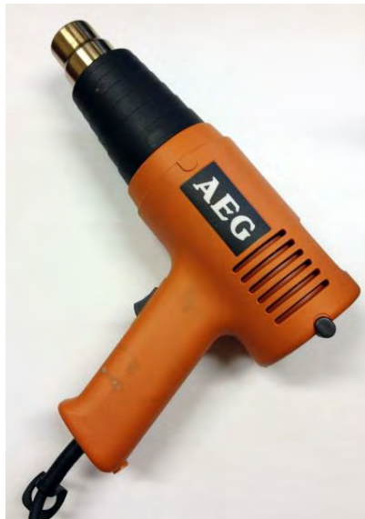
Figura A.14: pistola termica utilizzata per la somministrazione del calore
