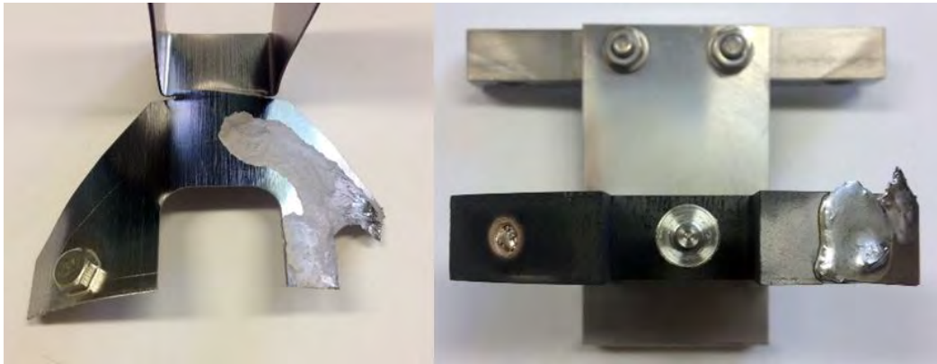
Figura 3.31: particolari della lamina danneggiata
