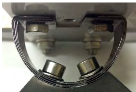
Figura 3.27: vista dei contatti elettrici nella lamina superiore prima del test
