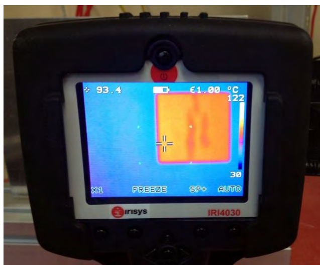
Figura A.15: misure di temperatura eseguite con la termocamera
