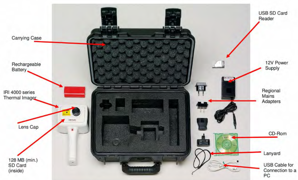
Figura A.12: Kit della Termocamera utilizzata: IRISYS Multi-Purpose Thermal Imagers IRI 4000 Series
