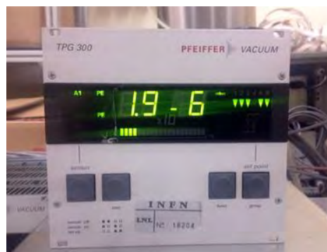
Figura B.7: Unità di controllo con interfaccia display per il monitoraggio delle pressioni registrate
