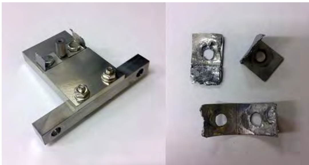
Figura 3.26: particolari della lamina danneggiata
