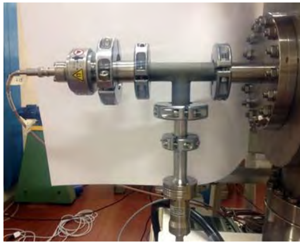
Figura B.6: Misuratori di alto vuoto Ga2 (a sinistra) e di basso vuoto Gb2 (in basso) opportunamente collegati alla testa flangiata del tripletto
