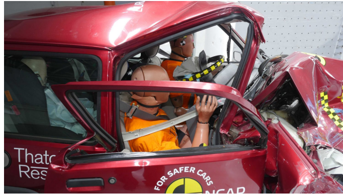
Figura 3.4. Crash test frontale una stella [16]
