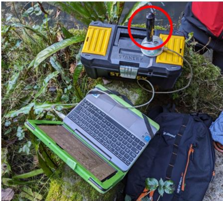
Figura 11: foto di un CTD-Diver, evidenziato in rosso, mentre vengono scaricati i dati su un PC portatile.
