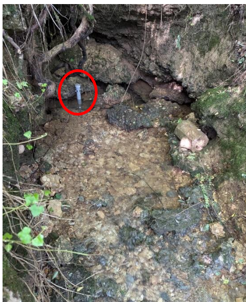
Figura 16: involucro contenete il CTD-Diver nella sorgente del Casselon.
