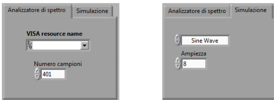
Figura 3.3: Parametri e opzioni contenute nei due tab: a sinistra per il funzionamento reale a destra per quello simulato.
