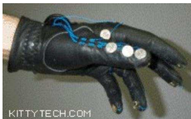
Figura 1.15: dispositivo VPL research Dataglove [10].
