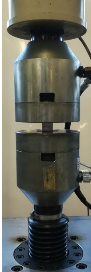
Fig.7.34: montaggio del provino nella Schenck per effettuare il CPC con carichi puramente assiali
