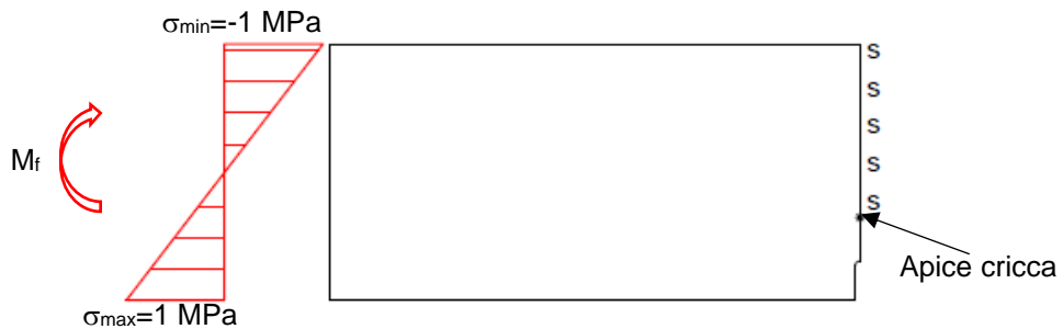
Fig.5.17: configurazione di carichi e vincoli utilizzati nel modello numerico. Nel piano di propagazione della cricca è applicata la condizione di simmetria.
