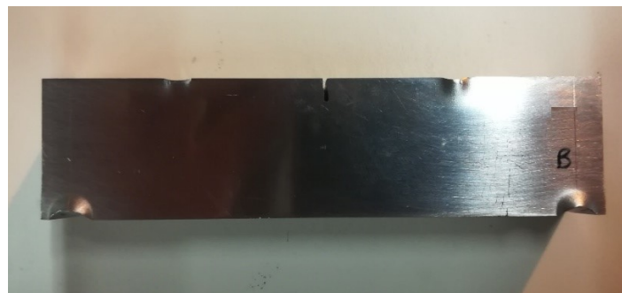
Fig. 7.28: zone plasticizzate del provino SENB1 dopo che è scivolato al di fuori degli appoggi a causa di un momento flettente fuori piano
