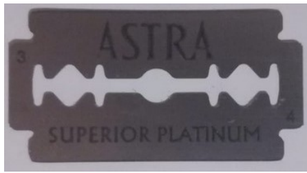
Fig.3.7: a sinistra le lamette che si utilizzeranno, mentre a destra la geometria approssimata delle lame utilizzate nel processo di razor blading. Lt è il tagliente della lama. In rosso è evidenziata la parte del tagliente che deve entrare in contatto con il provino. Le dimensioni del disegno sono in millimetri.
