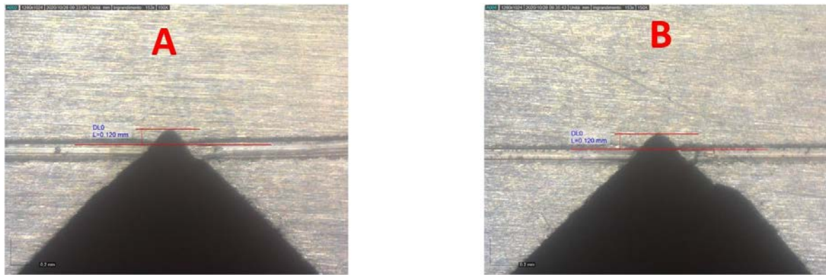
Fig.6.11: profilo del pre-intaglio P4 prima di iniziare l'intaglio da RB. È riportata anche la lunghezza di riferimento necessaria a ricavare a_{RB}
