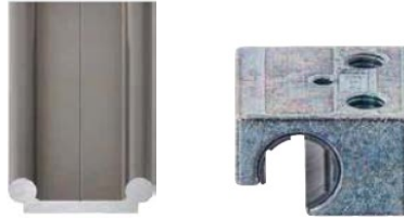
Fig.3.13: a sinistra la guida lineare a doppia corsia in alluminio anodizzato; a destra il cuscinetto che viene montato sulla guida. Il materiale di contatto è un tecnopolimero a basso coefficiente di attrito. I due componenti sono prodotti dalla ditta Iigus [4]
