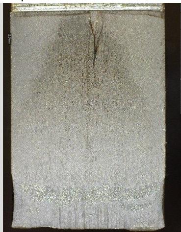
Fig.7.44: superficie di frattura del provino SENB2
