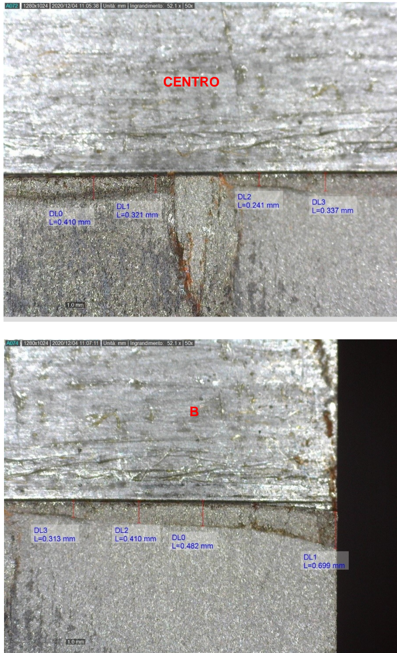
Fig.7.46: si riporta in dettaglio la linea di spiaggia della pre-cricca. Procedendo in ordine dall'alto verso il basso si ha: il lato A del provino SENB2, la parte centrale e il lato B. Sono riportate in diversi punti le lunghezze della pre-cricca.
