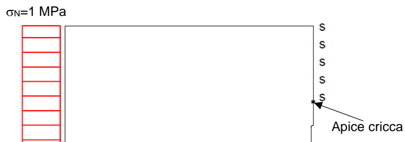
Fig.5.37: configurazione di carico e vincoli utilizzati nel modello numerico. In riferimento al piano di propagazione della cricca, la condizione di simmetria è applicata solo nella sezione resistente.
