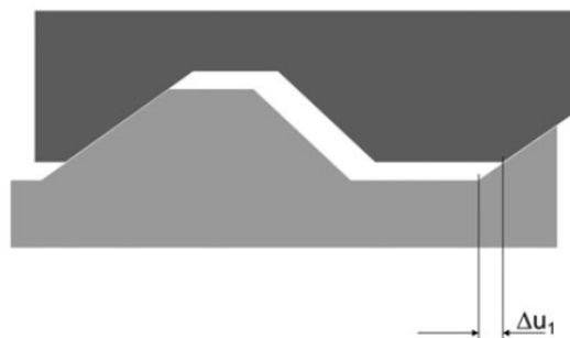
Fig.1.13: rappresenta le asperità presenti sulla superficie della cricca. Lo spostamento \Delta u_1 è causato dall'effetto locale del modo II che porta a contatto le superfici. [10]
