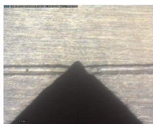
Fig.6.9: incisione effettuata con il truschino per avere un riferimento nella fase di misurazione dell'intaglio da RB.
