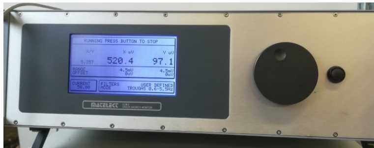
Fig.7.40: Matelect. Sistema di misura utilizzato per la misurazione della d.d.p. al propagare della cricca
