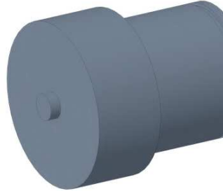
Figura 3.30: Estrusione di supporto per il posizionamento corretto dei perni.
