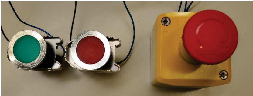
Figura 4.8: LED e fungo di emergenza collegati al PLC Master.
