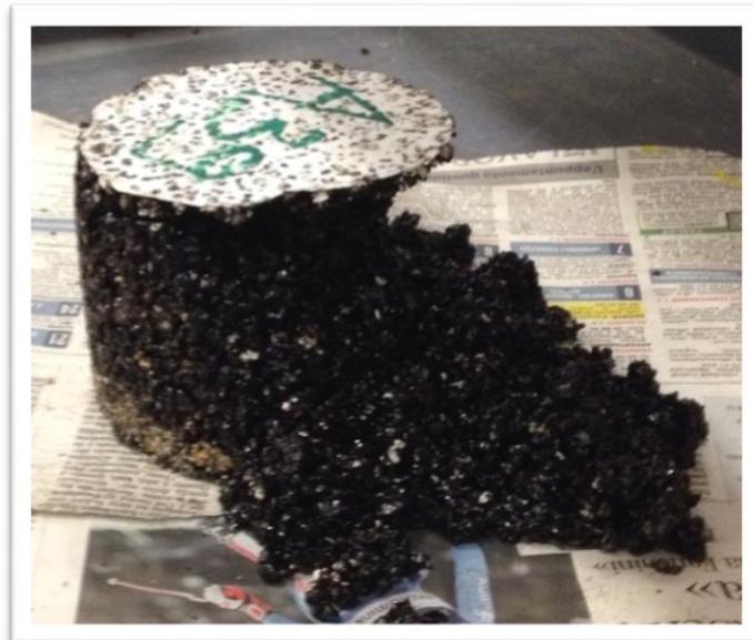
Figura 34: perdita consistenza del materiale dopo estrusione
