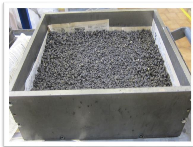
Figura 26: lastra per compattazione con pressa
