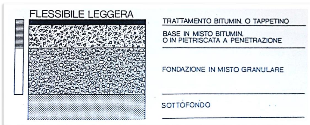
Figura 2: pavimentazione flessibile leggera
