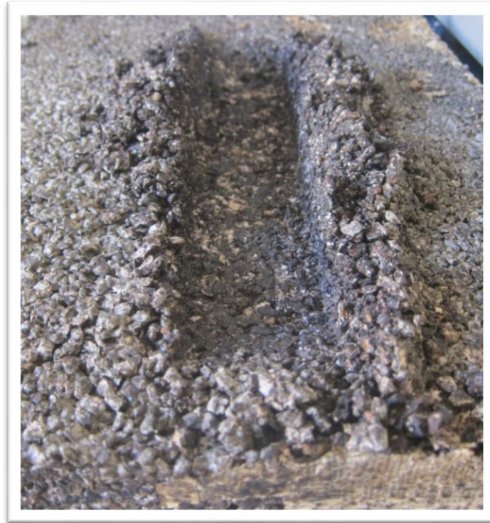
Immagine 39: materiale con solo cemento soggetto a tracciamento ruota
