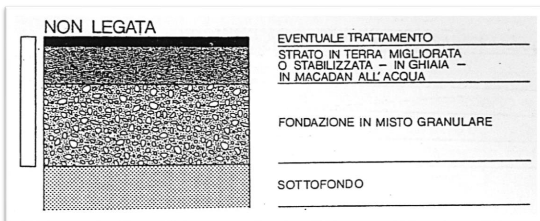
Figura 1: pavimentazione non legata
