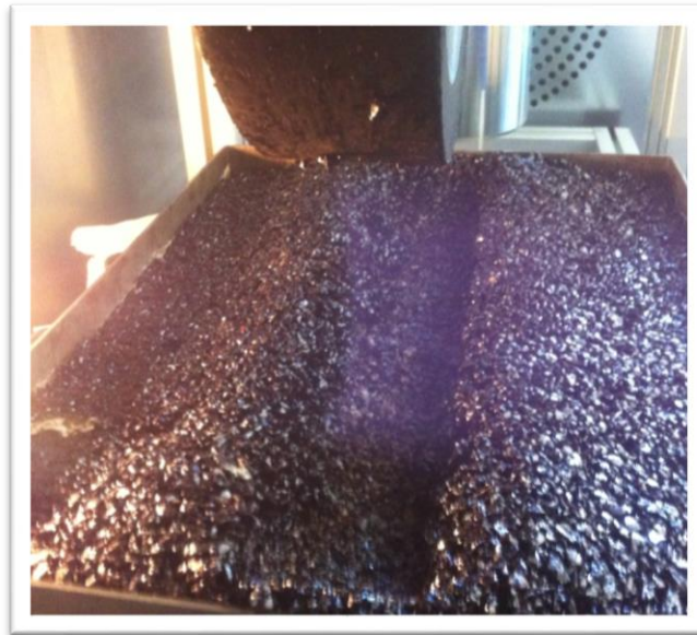
Immagine 38: materiale STD soggetto a tracciamento ruota
