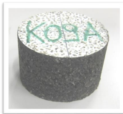
Figura 23: esempio di provino con compattazione Marshall
