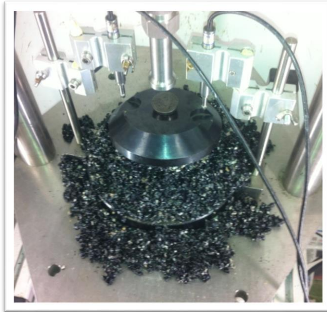
Figura 35: perdita consistenza del materiale durante la prova
