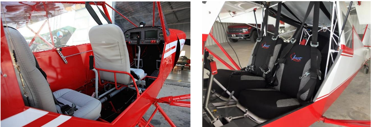
Figura 3-28(a) Aeromobile STOL biposto tandem; (b) Aeromobile STOL biposto affiancato.
