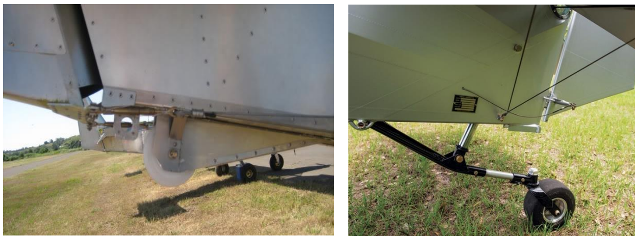
Figura 3-36 (a) Ruotino anticontatto per aeromobile triciclo STOL; (b) Ruotino di coda per aeromobile biciclo STOL.
