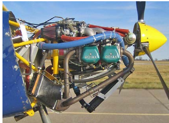
Figura 3-16(a) Rotax 912 ULS 100 [Hp]; (b) Particolare del motore e dell'elica.
