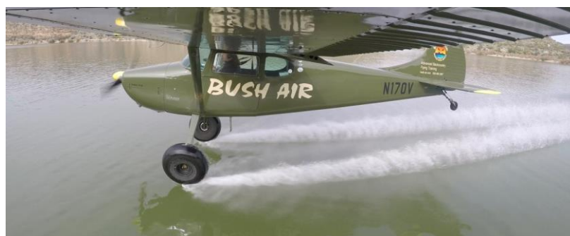
Figura 1-12 Cessna 170-B – Marche N170V in atterraggio con l'utilizzo della tecnica water skiing.
