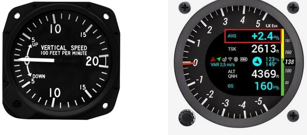
Figura 2-43 Variometro meccanico a pressione (a) e digitale (b).
