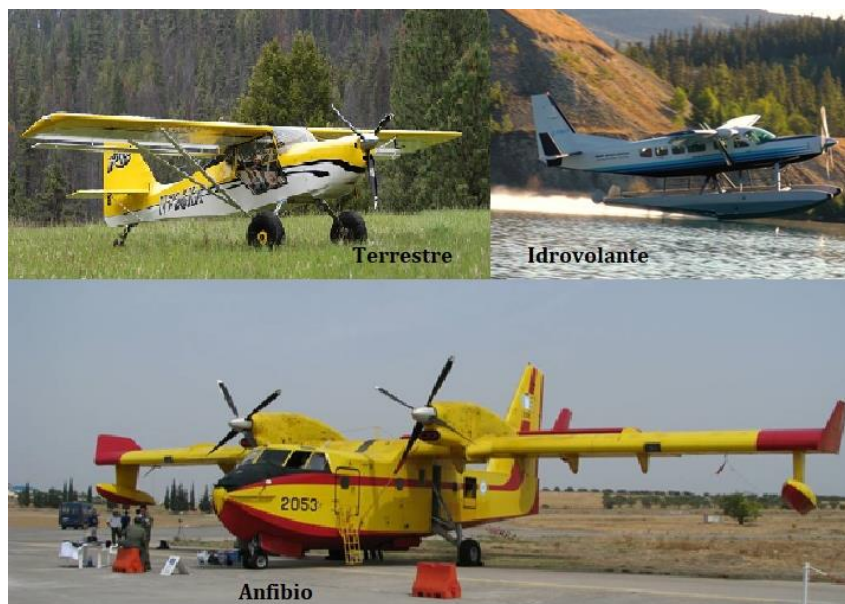
Figura 2-54 Panoramica delle tipologie di aeromobili a seconda della superficie di decollo ed atterraggio.
