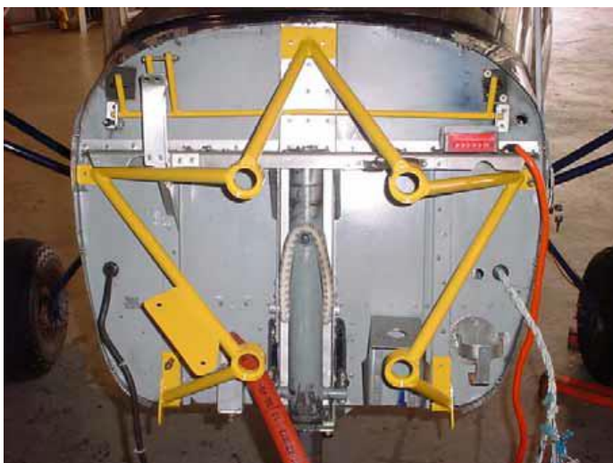
Figura 3-39 Castello motore per Rotax 912; (b) Suspension frame per Rotax 912.
