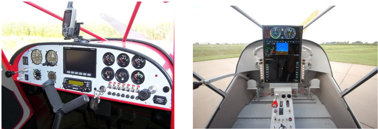
Figura 3-32(a) Pannello strumenti prevalentemente analogico; (b) Pannello strumenti completamente digitale.
