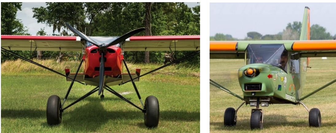
Figura 3-35(a) Carrello biciclo di un Just Aircraft SuperSTOL; (b) Carrello triciclo di un ICP Bingo.
