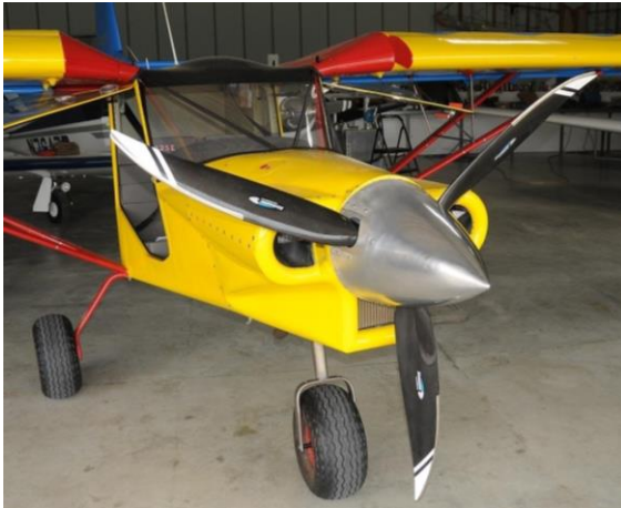
Figura 3-18(a) Elica tripala in composito; (b) Meccanismo di variazione del passo geometrico.
