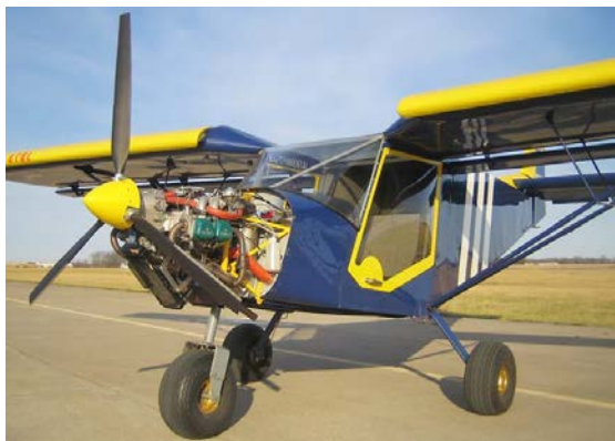
Figura 3-16(a) Rotax 912 ULS 100 [Hp]; (b) Particolare del motore e dell'elica.
