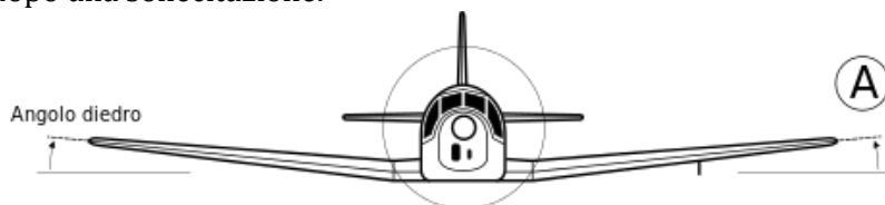
Figura 2-30 Definizione di angolo diedro alare.
