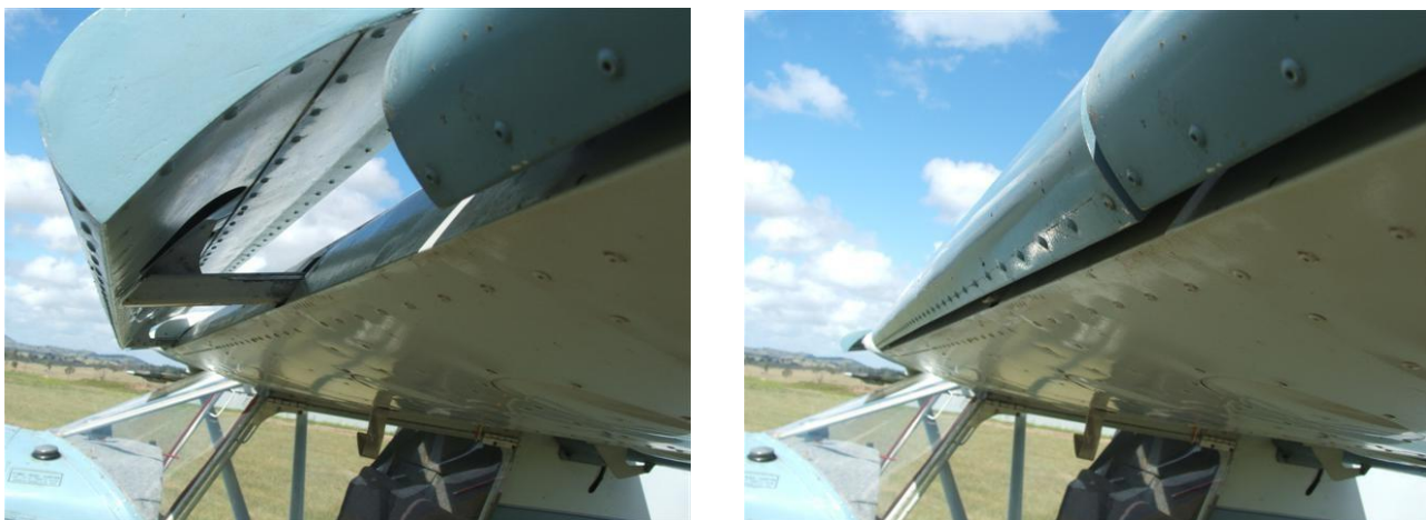
Figura 3-6 (a) Sistema PegaSTOL esteso; (b) Sistema PegaSTOL retratto.
