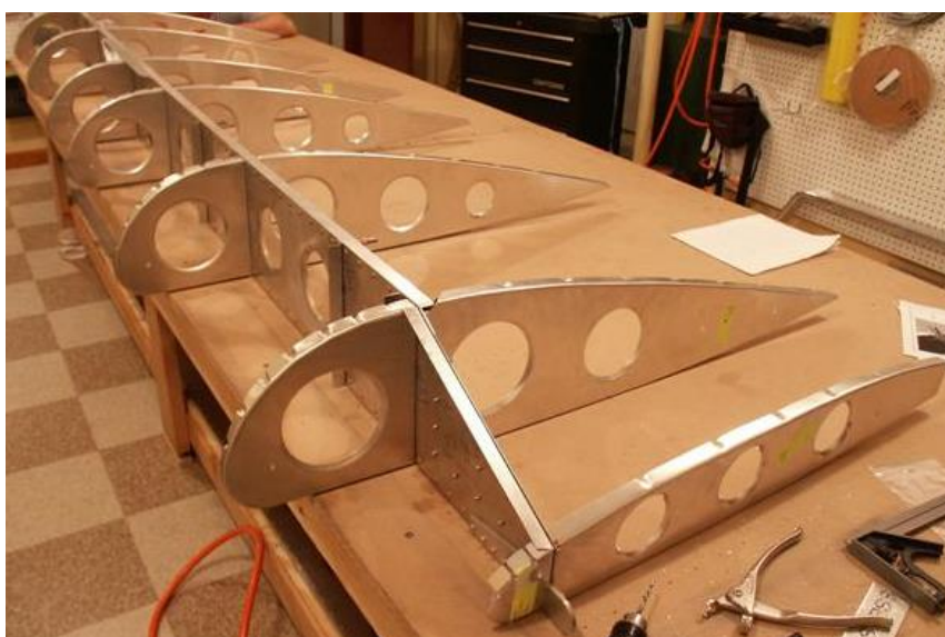
Figura 3-42 Centine fissate a longherone anteriore su una semiala di uno Zenith CH 701 STOL.
