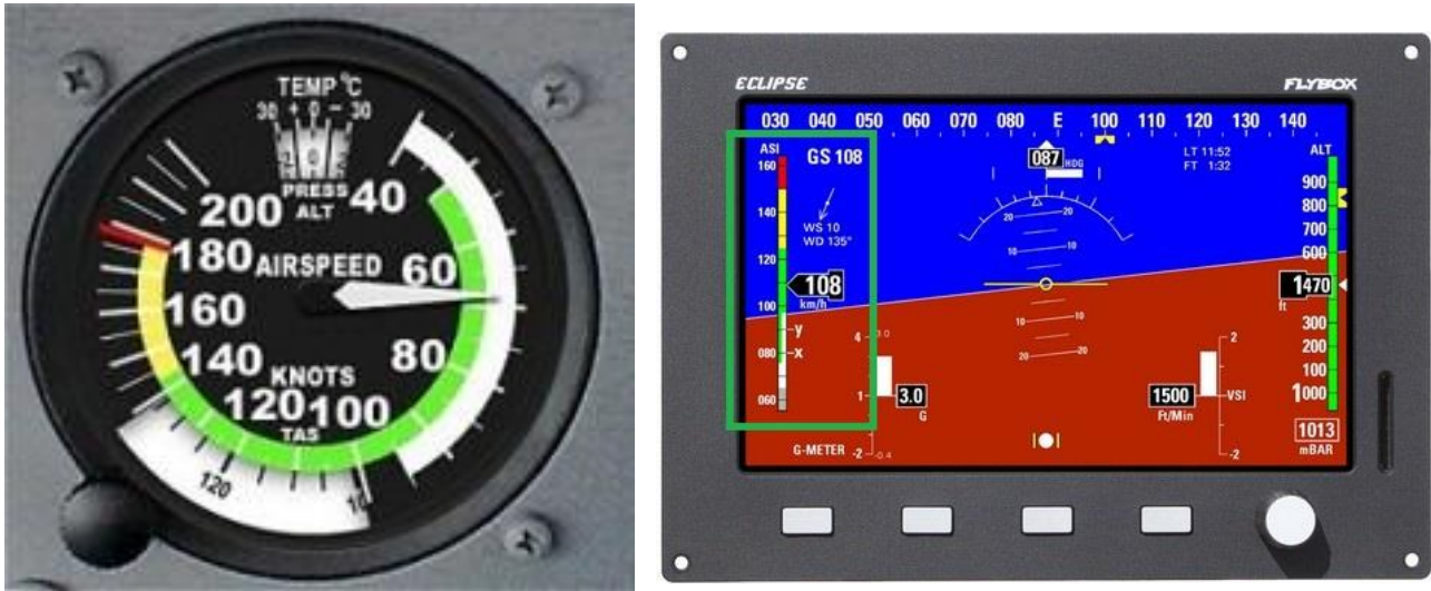
Figura 2-52 (a) Anemometro meccanico a pressione e (b) digitale con le rispettive legende.
