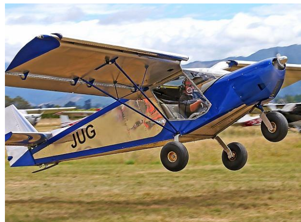
Figura 2-69 (a) Traiettoria di decollo corto rullato; (b) Zenith CH 701 STOL in rotazione durante decollo corto.
