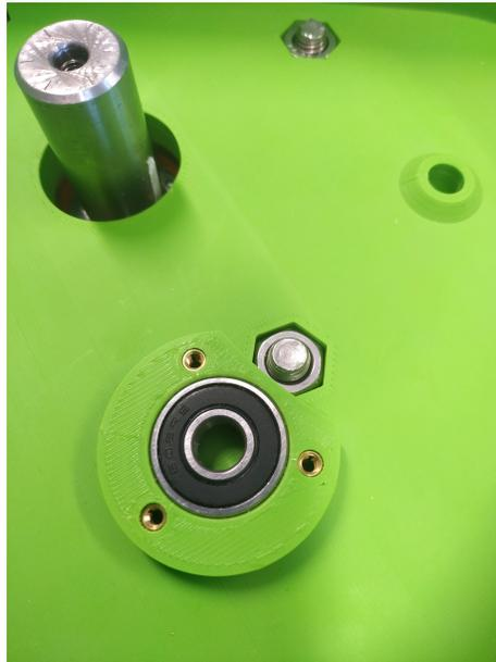
Figura 70: Zoom del cuscinetto con inserti in ottone per fissaggio del blocca cuscinetto
