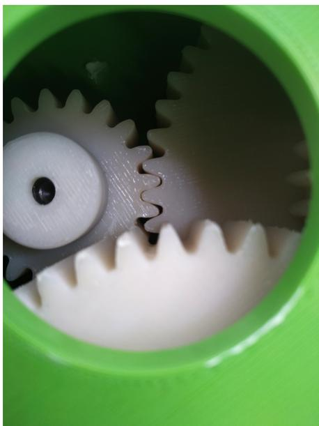
Figura 75: Zoom sulla finestrella per l'ispezione delle ruote dentate .
