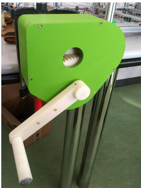
Figura 74: Moltiplicatore di giri completamente assemblato .
