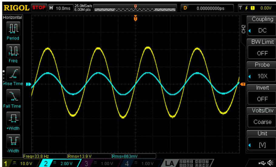
Figura 94: Esempio misurazione tensione (giallo) e corrente (blu) con l'oscilloscopio .
