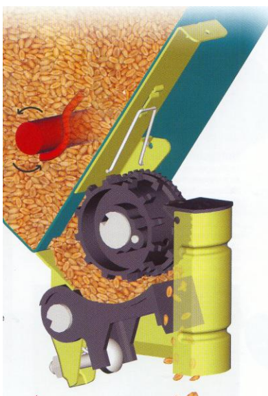
Foto 14: particolare disco distributore
