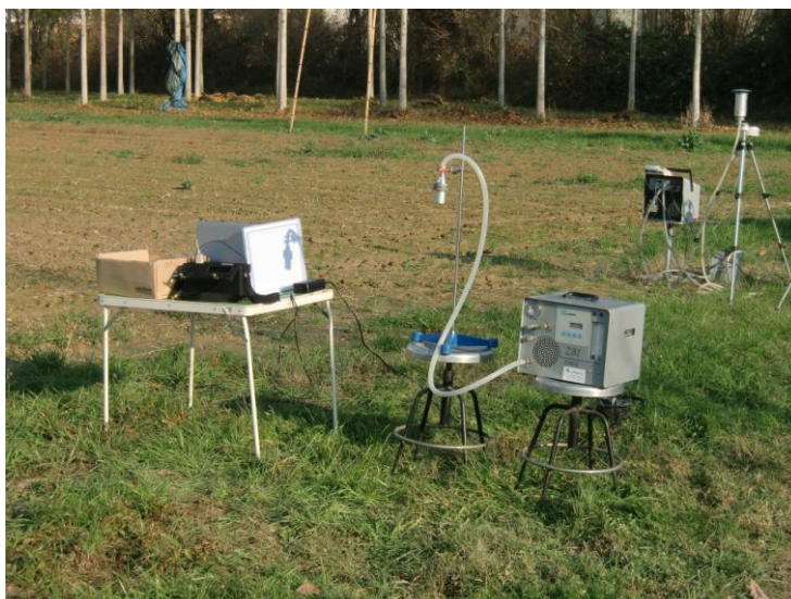
Foto 21: rilevatori PTS e PM
