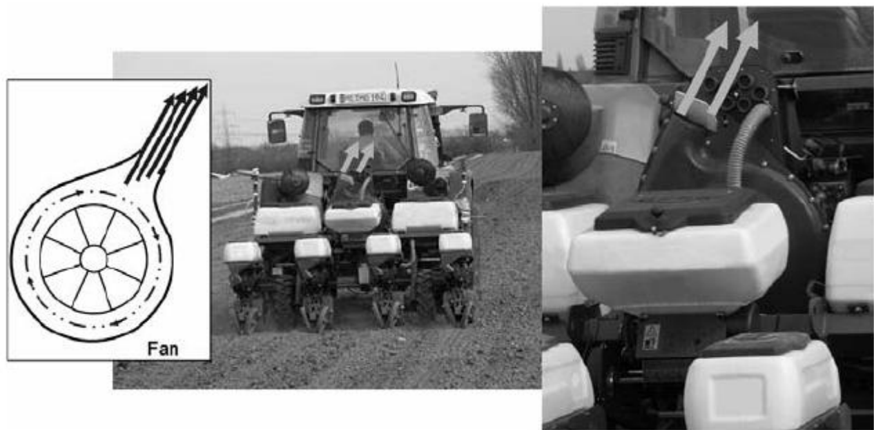
Foto 20: illustrazione funzionamento ventilatore centrifugo a depressione montato su Monosem 4 file
