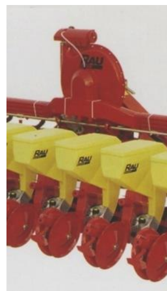
Foto 16: particolare ventilatore centrifugo aspirante
