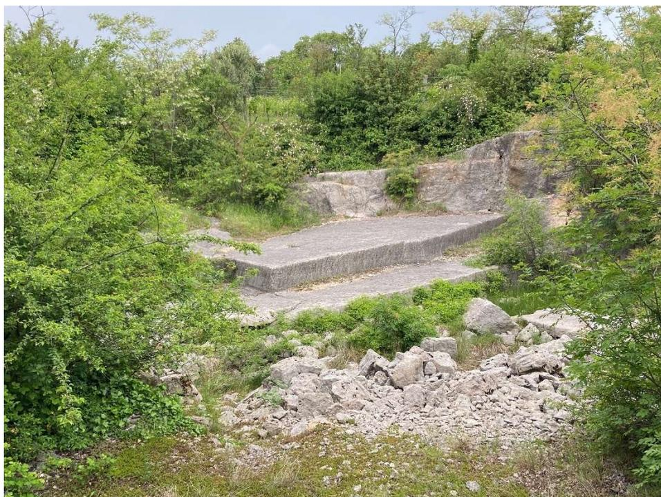
*Fig. 35 Cava abbandonata in località Ca de la Pela (Cava 75; Sant'Ambrogio di Valpolicella): da notare la conformazione e l'estensione dei vecchi banchi di roccia esposti da cui si cavano i blocchi.*
