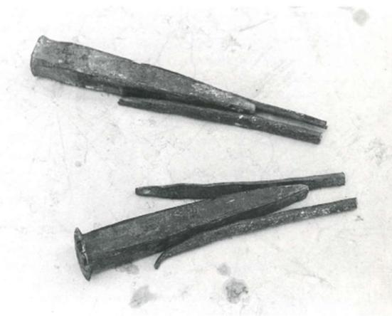
Fig. 37 I "ferri del mestiere" di ogni cavatore: sopra i ponceti (BRUGNOLI, DIONISI 1999d, pp. 47-48).
