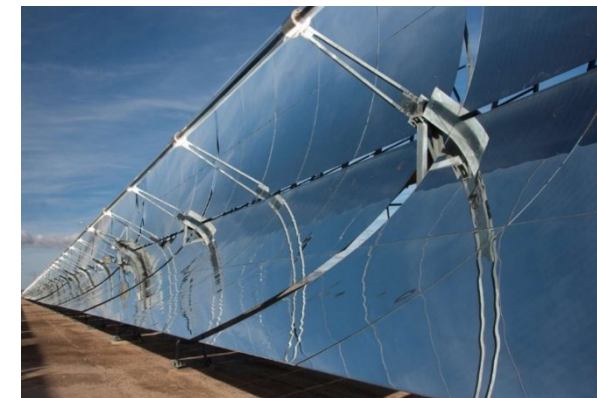
Figura 3: concentratore solare cilindrico-parabolico [1]
