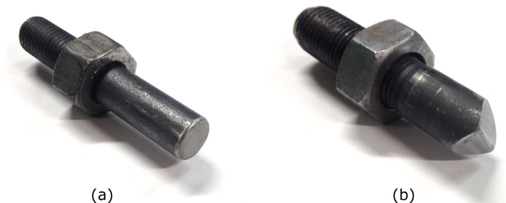
Figura 10.1 Punzoni utilizzati nelle prove. (a) prove statiche. (b) prove a carichi ciclici.
