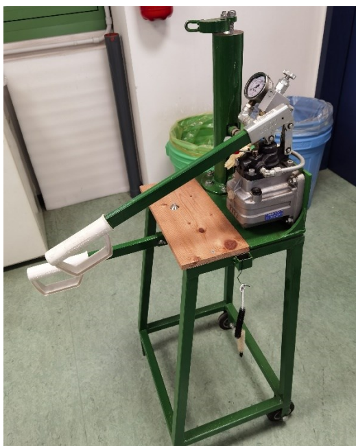
Figura 6.13: Pressa idraulica utilizzata per la produzione della pastiglia di segatura (Foto: Pradel N., 2022)
