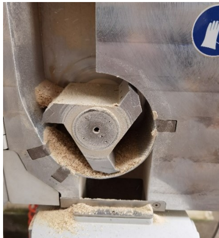
Figura 6.12| Dettaglio del mulino a coltelli (Foto: Pradel N., 2022)
