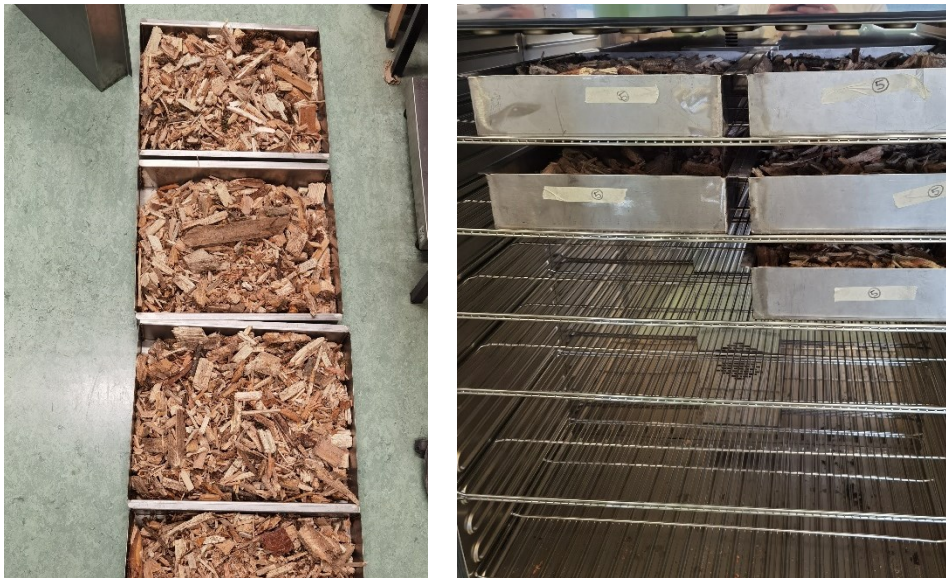
Figura 6.3: Essiccazione dei campioni di cippato (Foto: Pradel N., 2022)
