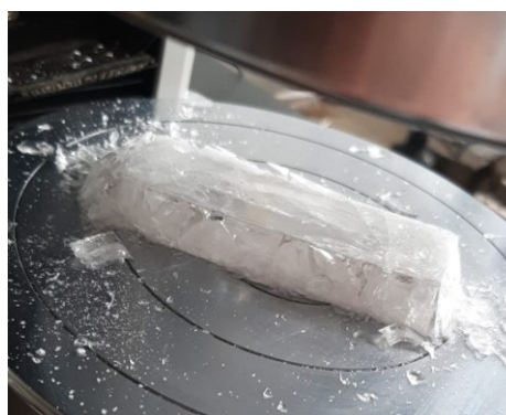
Figura 61 - Provino BE_A reticolato a 5°C al termine della prova di compressione
