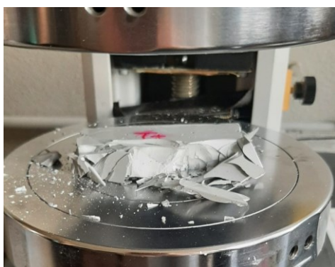
Figura 60 - Provino BSE_RTE reticolato a 5°C al termine della prova di compressione
