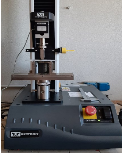
Figura 16 - Set up del dinamometro per prove meccaniche di flessione
