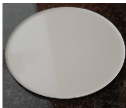
Figura 54 - Esempio di provino BS RC reticolato per più di 10 giorni a 25°C
