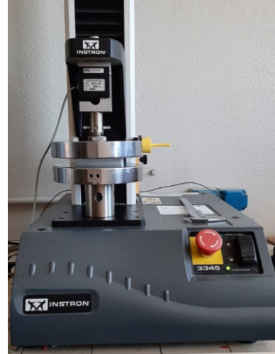
Figura 17 - Set up del dinamometro per prove meccaniche di compressione
