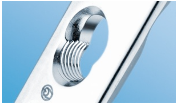
Fig. 4.6 – Dettaglio di un foro ibrido combi-hole ™ in una placca di tipo LCP. In basso si può osservare la porzione filettata, che accoglie viti bloccate; la porzione in alto invece è analoga a quella delle placche DCP e accoglie viti tradizionali, comprese le lag screw .
