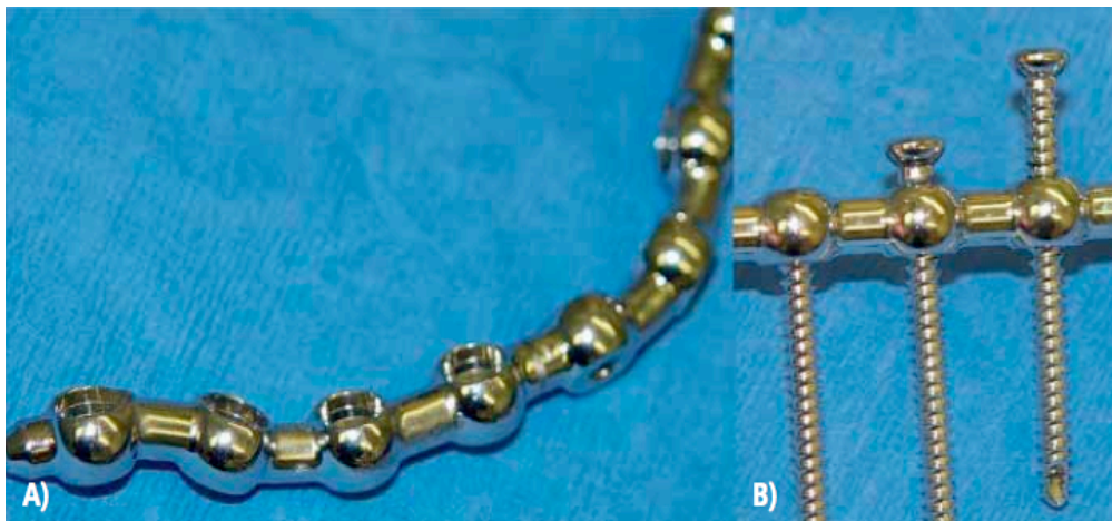
Fig. 4.11 – Sistema a stabilità angolare String-of-Pearls da 3.5 mm. L'impianto può essere piegato con sei gradi di libertà (A), ed accoglie viti corticali che sono in grado di fornire stabilità angolare innestandosi nella filettatura del foro (B) (Ness, 2009).
