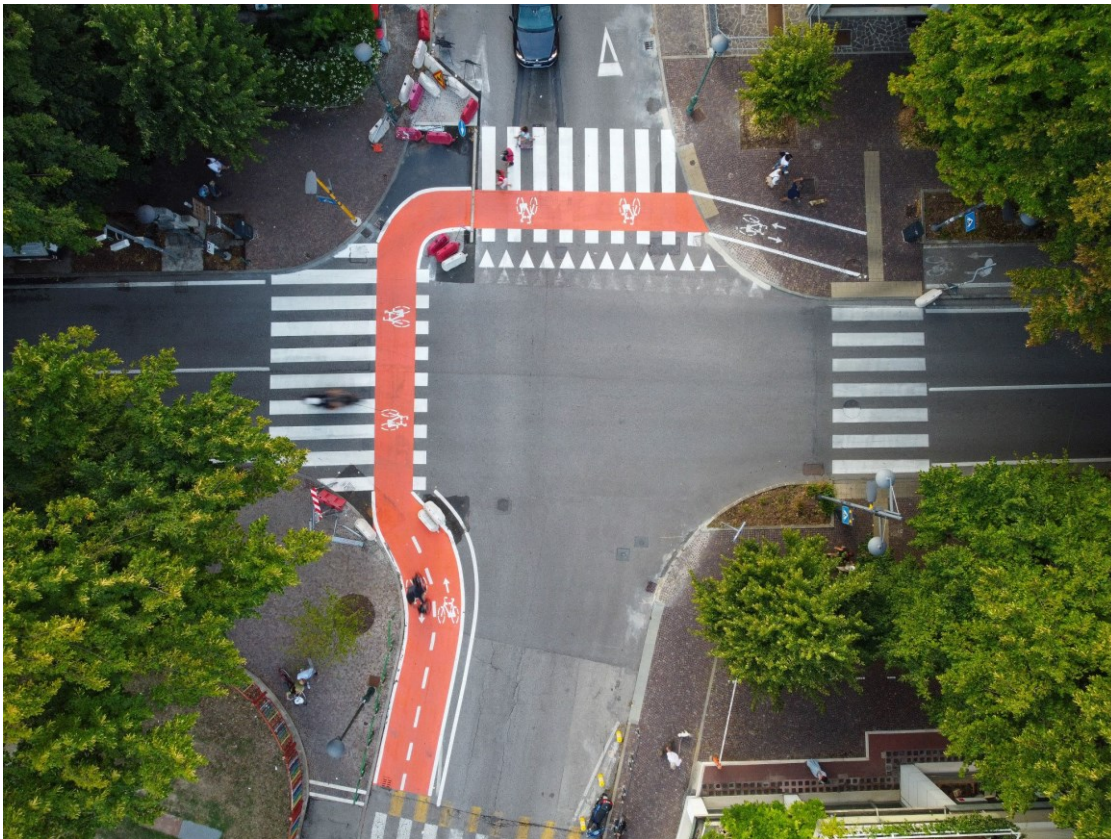
Figura 45 | Interventi di messa in sicurezza della mobilità ciclistica all'intersezione tra via Spalti e via Garibaldi Foto di Stefano Marchiante
