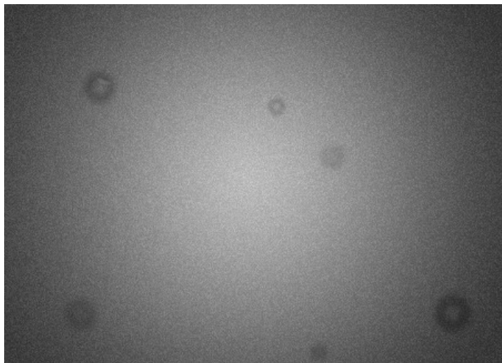
Figura 2.7: Esempio di immagine ottenuta illuminando il sensore in modo uniforme, detta anche immagine di flat field. Sono visibili degli anelli scuri causati dalla presenza di polvere sul filtro oppure sulla finestra.
