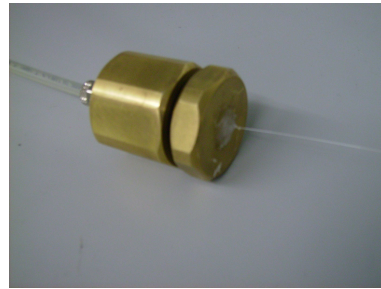
(b) Cella di pressione per iniettare l'azoto nella fibra
