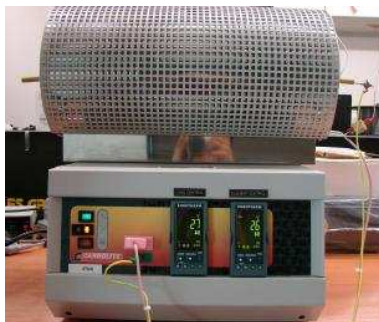
Figura 2.4: Forno in cui si inserisce il sensore per valutarne la risposta termica
