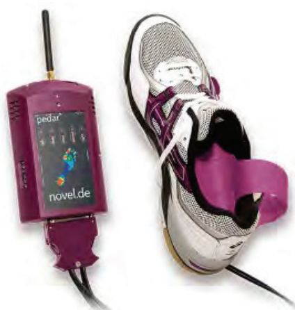
Figura 2.10 Solette con cavo, evoluzione delle pedane, Novel Pedar X, GmbH Germania.
