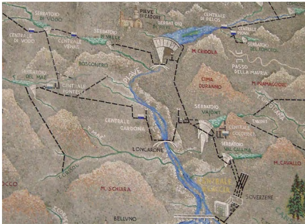
Figura 1.3: Mosaico della centrale Achille Gaggia di Soverzene che schematizza il sistema Piave, Boite, Maè, Vajont, Val Gallina
