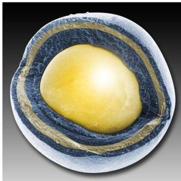
Figura 6: Primo piano su una palla TRISO che dettaglia il nucleo (in giallo) e i 3 strati protettivi. Fonte: *Meta-Défense.fr*
