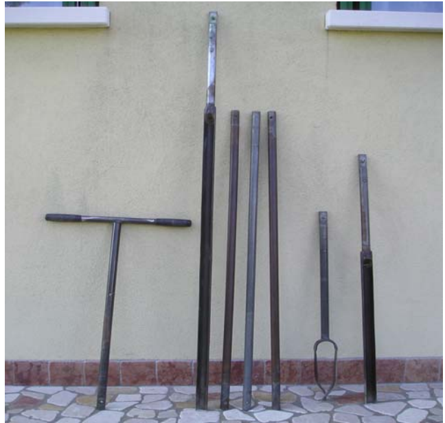
figura 4. Trivella di tipo olandese utilizzata nei sondaggi manuali
