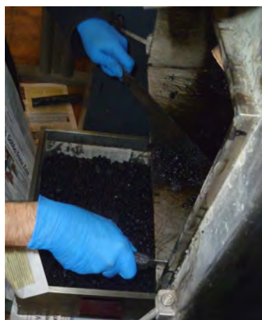
Figura 4.10: stesura conglomerato sulla lastra.
