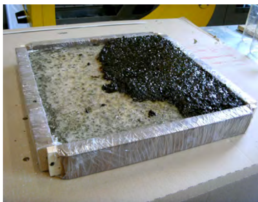
Figura 4.7: fase di stesura della pavimentazione.
