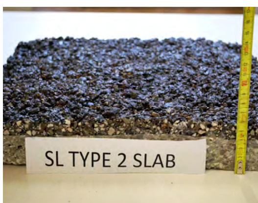
Figura 4.8: esempio di lastra (A-2-C-75) confezionata con soluzione A.
