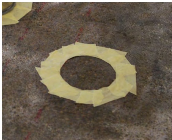
Figura 4.35: particolare preparazione superficie per incollaggio.
