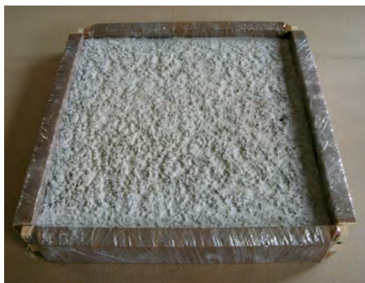
Figura 4.6: lastra in calcestruzzo pronta per stesura pavimentazione.
