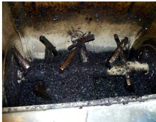
Figura 4.9. miscelatrice impiegata per produrre il conglomerato bituminoso.
