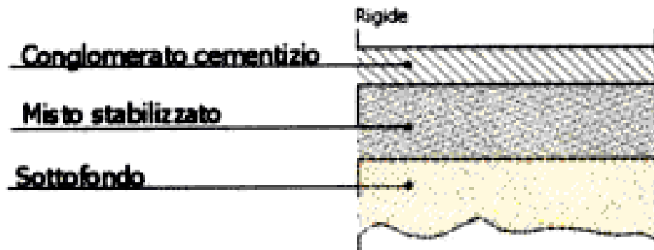
Figura 1.5: stratigrafia pavimentazione rigida.
