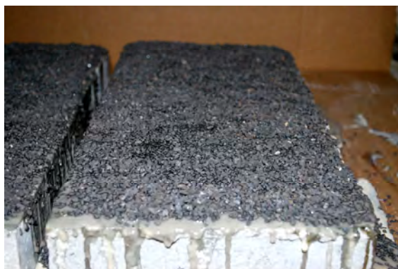
Figura 4.15: fase ultimata di stesura della Bauxite a creare la tessitura superficiale.
