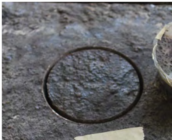
Figura 4.33: esempio di incisione su lastra Diametro 50 mm e profondità 35 mm.
