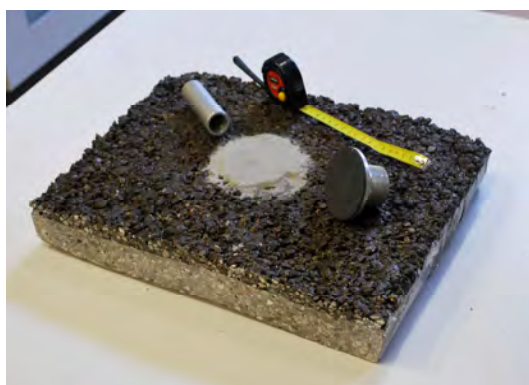
Figura 4.22: attrezzatura impiegata per prova altezza in sabbia.
