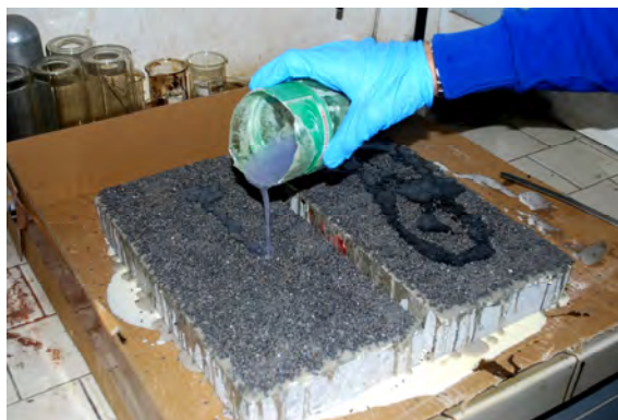
Figura 4.16: fase di stesura strato finale.
