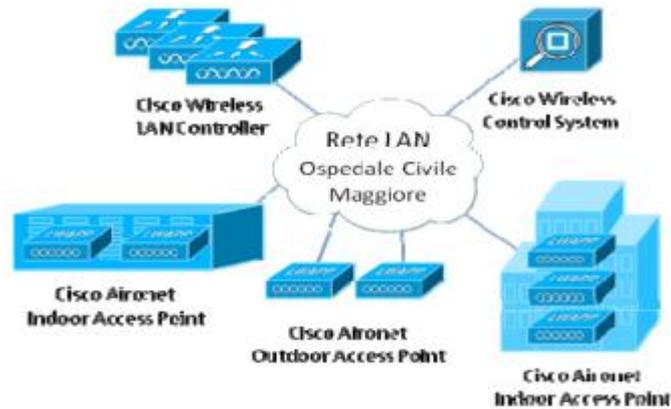
Figura 7: Schema funzionale rete WI-FI
