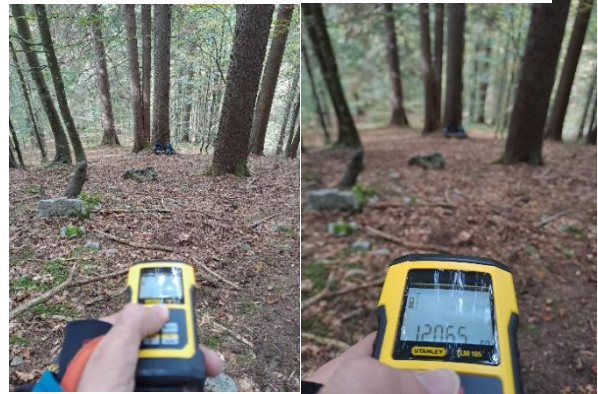
Figura 4-5: utilizzo del distanziometro per misurare il raggio dell'area di saggio
