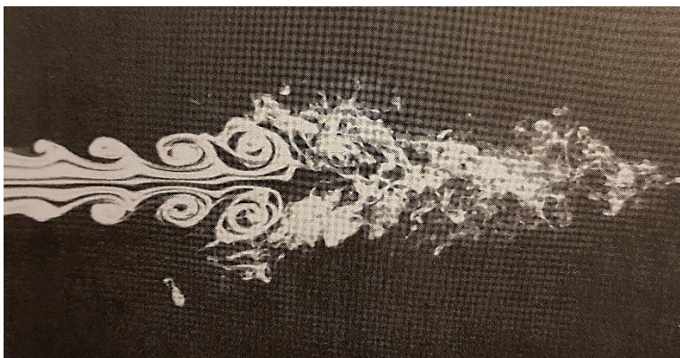
Figura 1.23 Vortici di turbolenza in un fluido ("Introduction to Computational Fluid Dynamic, A. Dal Monte)
