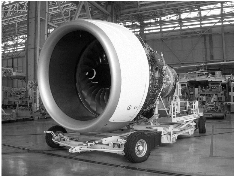
Figura 1.2 Esempi di turbomacchine assiali a flusso comprimibile
