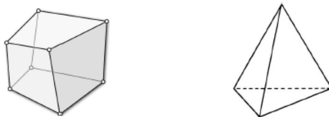
Figura 2.6. Elementi delle mesh volumetriche: a) esaedro; b) tetraedro
