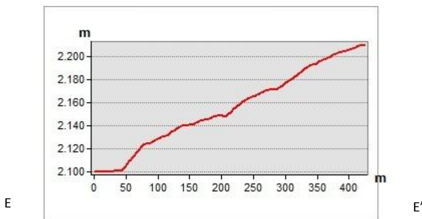
Fig 4. Profilo longitudinale del deposito glaciale della valle del Lagusel. Si nota l'aumento progressivo del rilievo tra la base della fronte morenica e i detriti del rock glacier. Le misure sono espresse in m.
