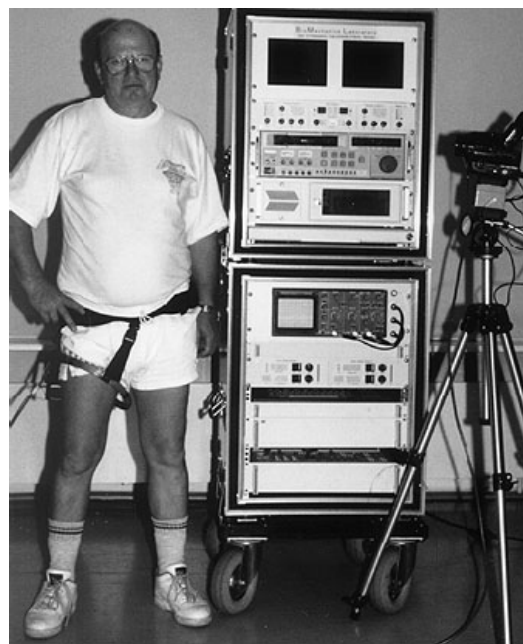
Figura 2.4: paziente con sistema telemetrico per la misura della temperatura al fine di valutare un'eventuale mobilizzazione della protesi d'anca.
