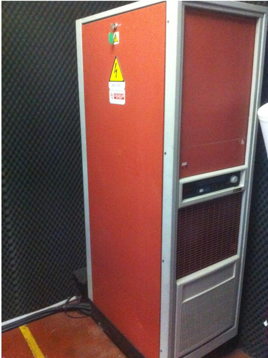
Fig. 2.2: L'amplificatore dello shaker
