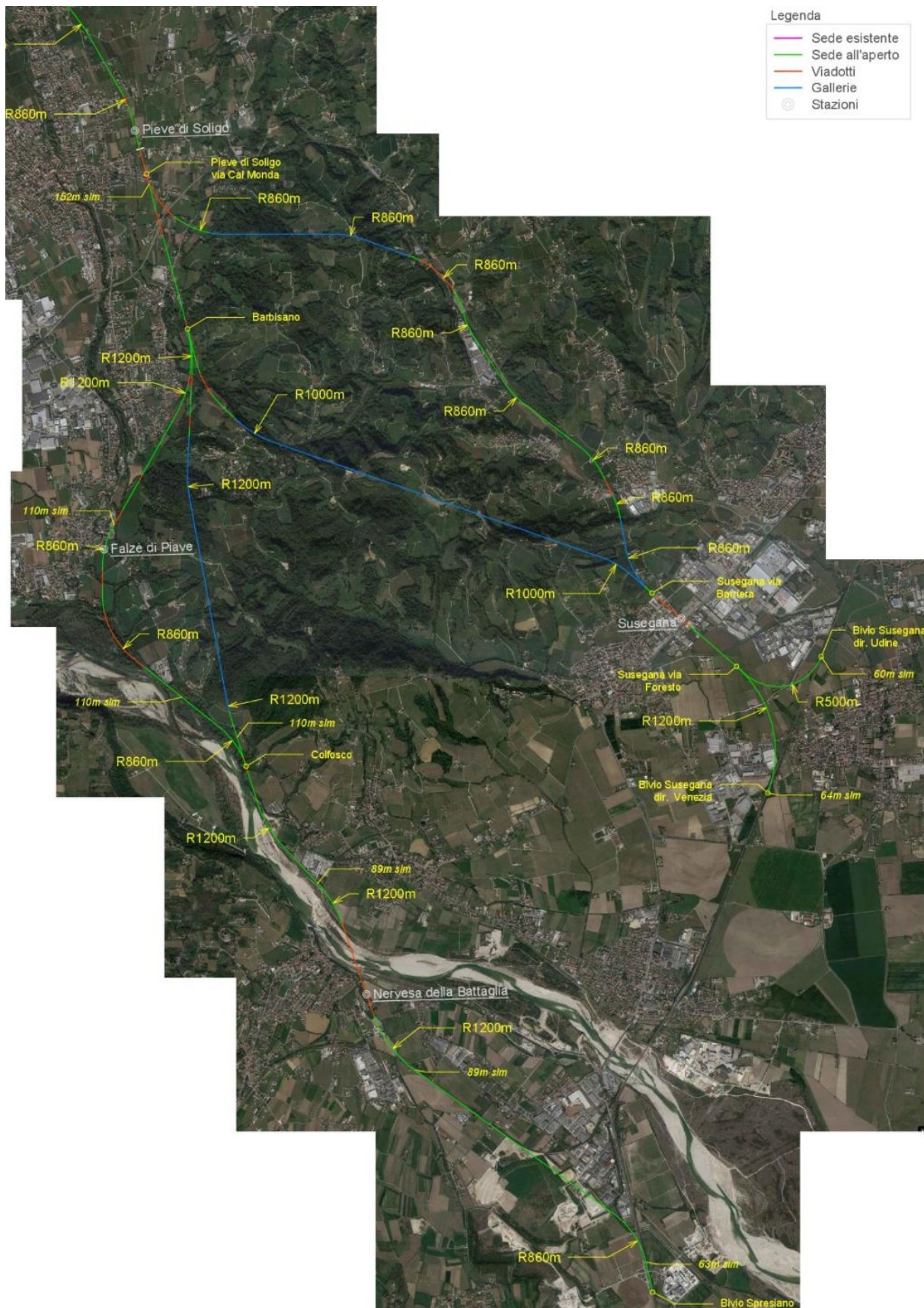
Figura A - 1: planimetria del tracciato, suddiviso per tipologia di sede, per la sezione Spresiano/Susegana – Pieve di Soligo della linea San Boldo.
