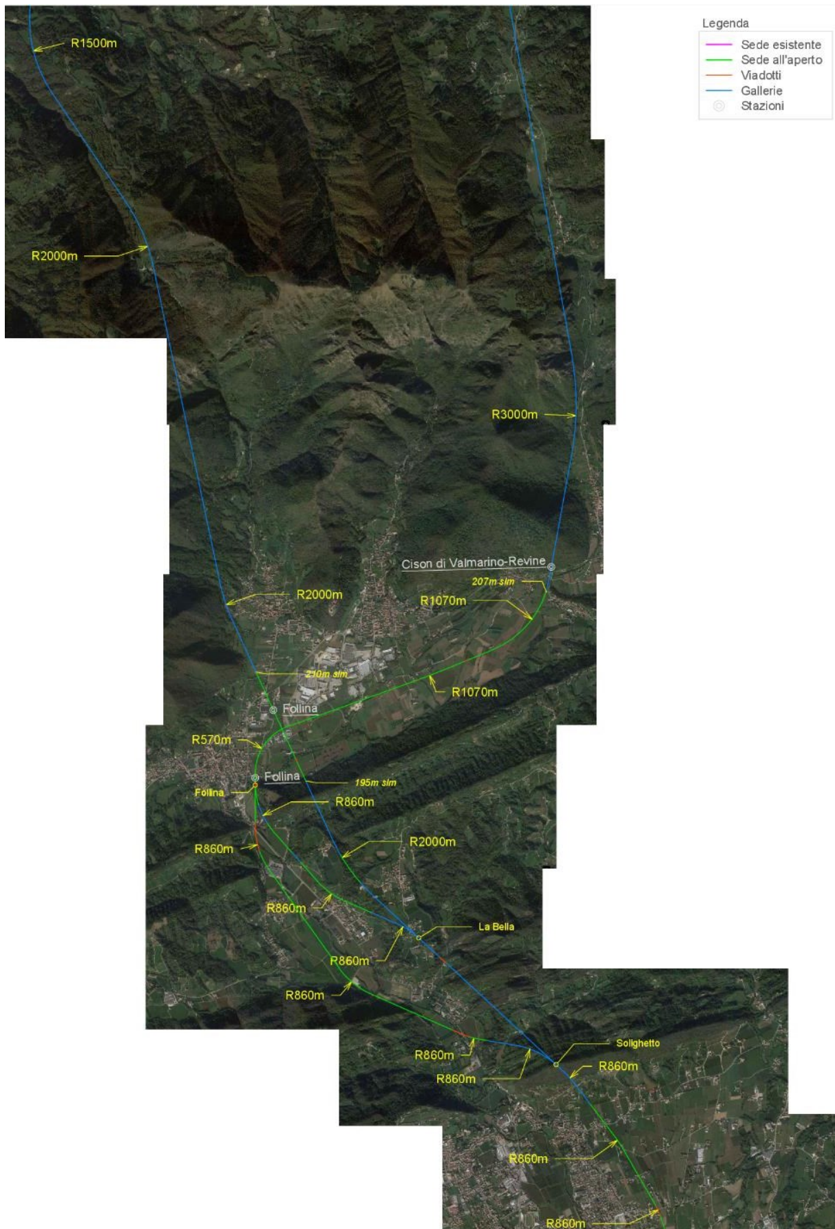
Figura A - 2: planimetria del tracciato, suddiviso per tipologia di sede, per la sezione Pieve di Soligo – Galleria di valico della linea San Boldo.
