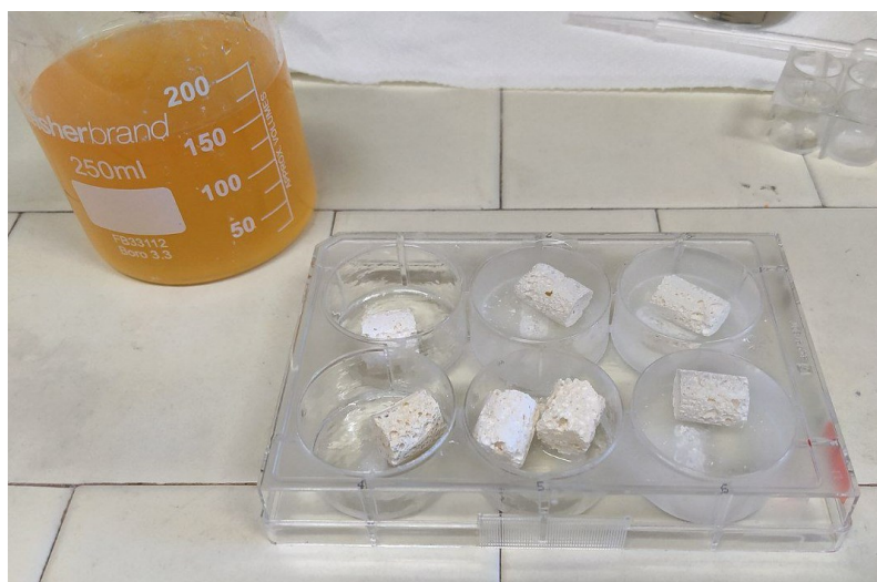
Figura 29: Campioni di bioceramico funzionalizzati con gli scarti di lavaggio nel becker a sinistra dell'immagine.
