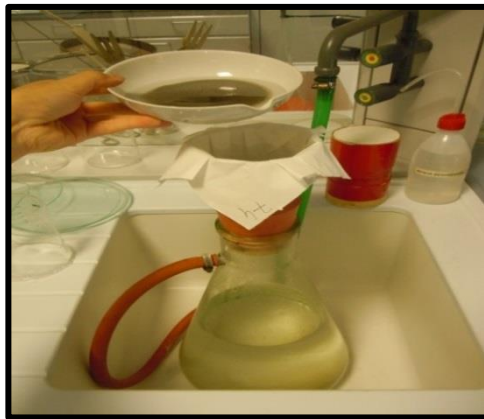
Figura 16: pompa a vuoto aspirante l'acqua rimanente.
