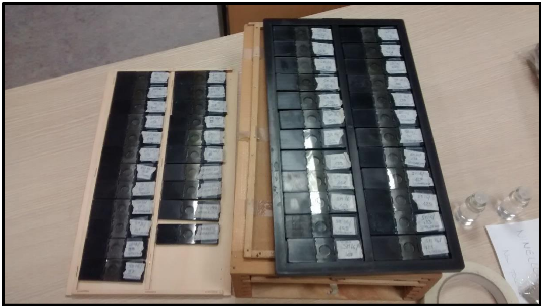
Figura 20: vetrini porta campione a una celletta con esemplari pronti per la pulizia.
