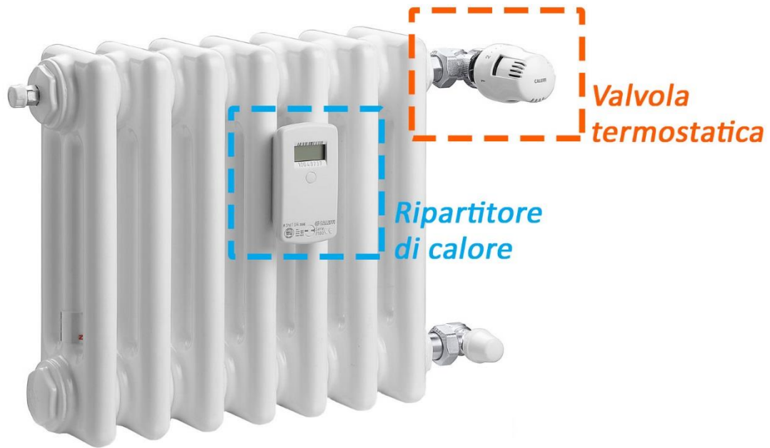
Figura 33: Sistema di contabilizzazione indiretta con ripartitore e valvola termostatica
