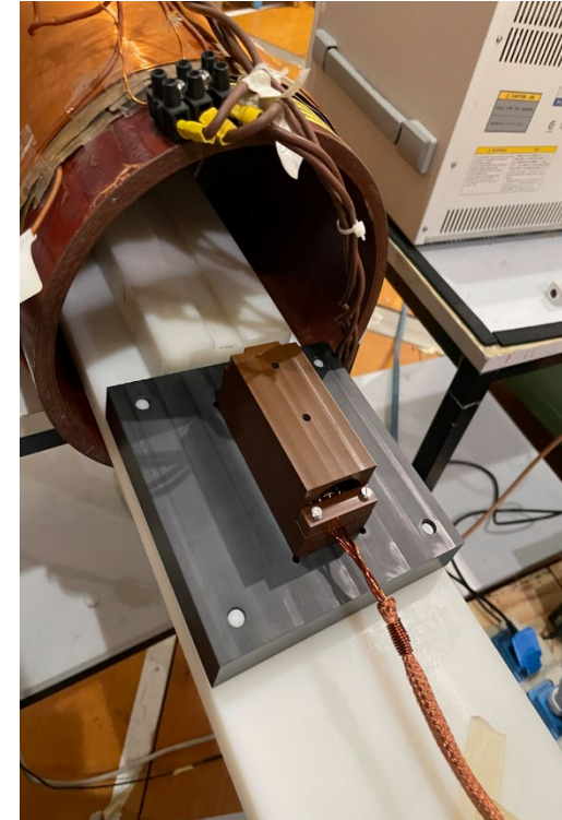
Fig.2. Sensore Flux-Gate montato sul supporto realizzato
