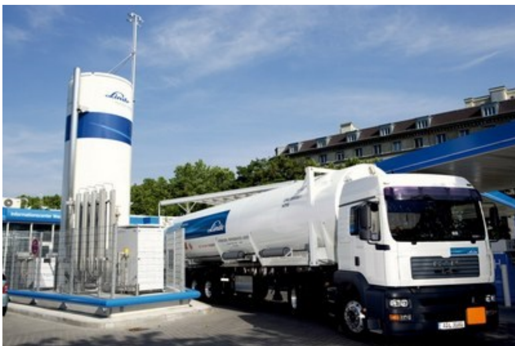
Figura 19 Autotreno allestito per il trasporto di idrogeno liquido
