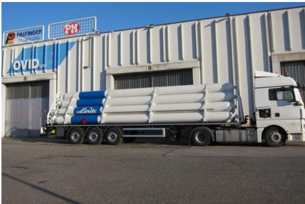
Figura 18. Autotreno allestito per il trasporto d'idrogeno gassoso
