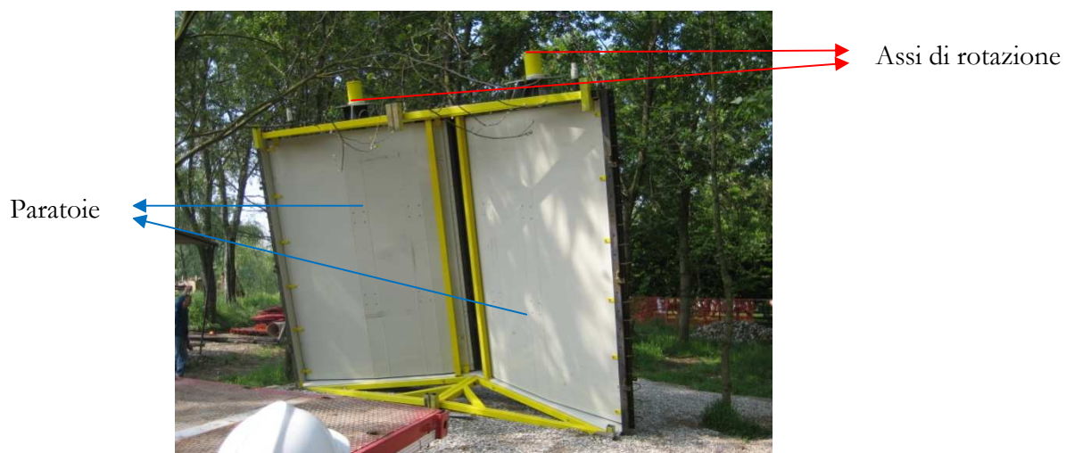
Figura 16-Vista della paratoia rotativa.
