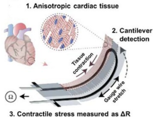
Figura 2.4 – Illustrazione schematica di un MEA flessibile ed elastico integrato con un estensimetro per la misurazione delle deformazioni cardiache.
