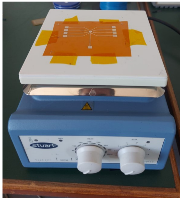
Figura 5.11 – Curing della metal pattern del MEA sulla piastra riscaldante Stuart US150.
