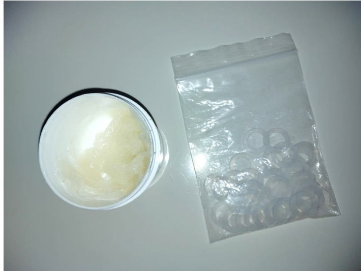
Figura 6.10 – Grasso alimentare (sinistra) utilizzato per attaccare l'O-ring (destra) al sensore.
