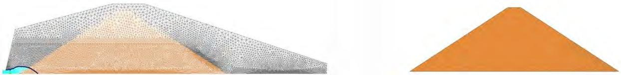
Fig. 6.9 - A Sx, Mesh del Dominio Fluido Euleriano - A Dx, Mesh del Dominio Strutturale Lagrangiano;
