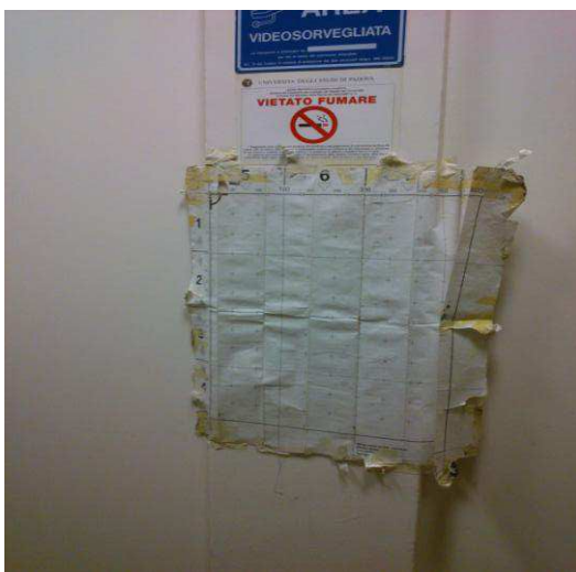
Fig. 6.2. Posizionamento del reticolo di riferimento per l'esecuzione di una prova su un setto
