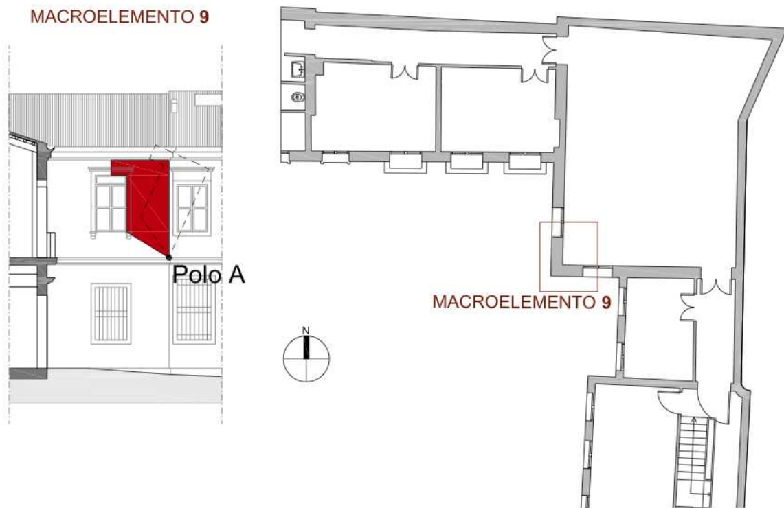
Fig. 7.28. Individuazione e schematizzazione del cinematismo 4 nel macroelemento 9
