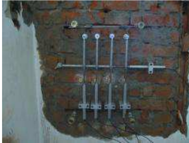
Fig. 6.28. Schema di disposizione dei sensori nel test di martinetto piatto doppio
