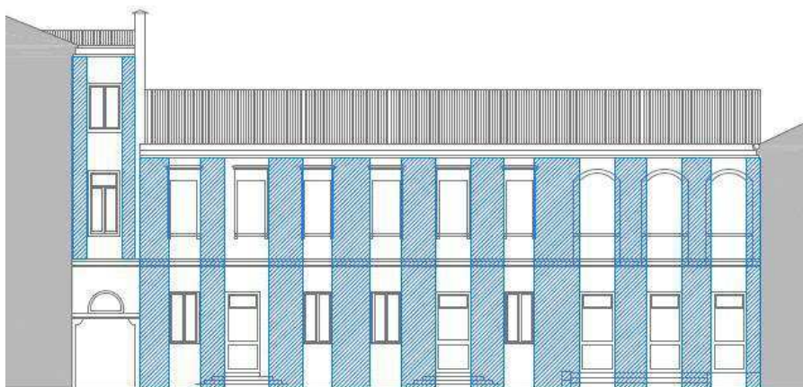
Fig. 4.55.distribuzione maschi murari prospetto corpo nord verso cortile
