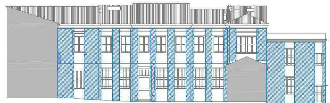
Fig. 4.57.distribuzione maschi murari prospetto corpo est verso
