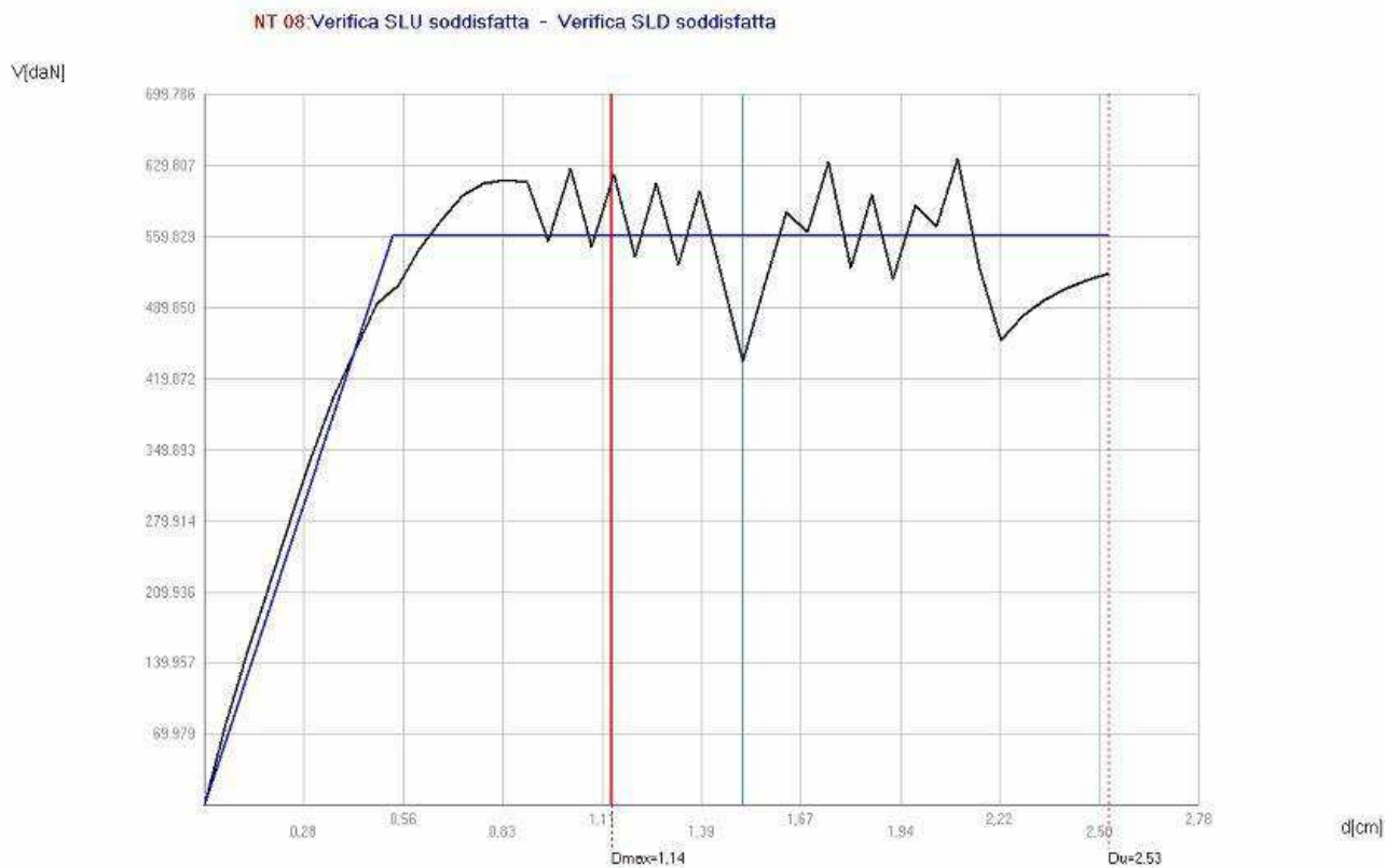
Fig. 7.96. Curva di capacità nell'analisi 12 con sisma in direzione +X, ove l'asta verticale in rosso indica lo spostamento massimo consentito del punto di controllo allo Stato Limite di salvaguardia della Vita.
