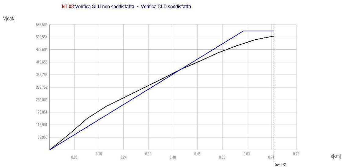
Fig. 7.92. Curva di capacità nell'analisi 24 con sisma in direzione -Y, ove l'asta verticale in rosso indica lo spostamento massimo consentito del punto di controllo allo Stato Limite di salvaguardia della Vita.
