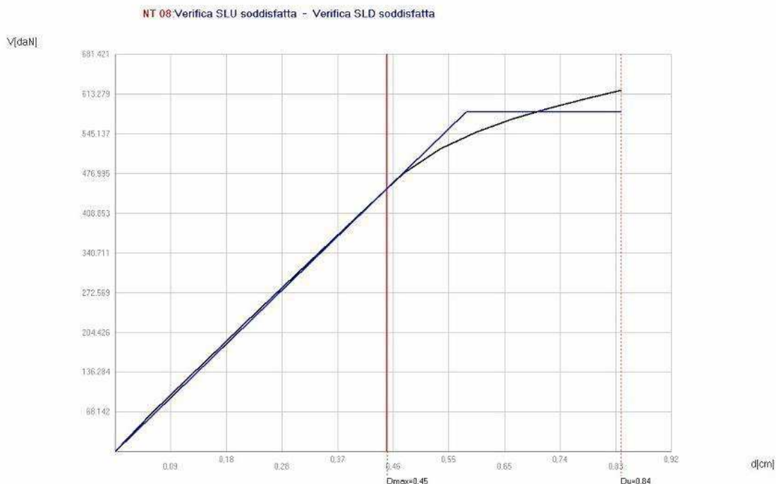
Fig. 8.121. Curva di capacità nell'analisi 24 con sisma in direzione -Y, ove l'asta verticale in rosso indica lo spostamento massimo consentito del punto di controllo allo Stato Limite di salvaguardia della Vita
