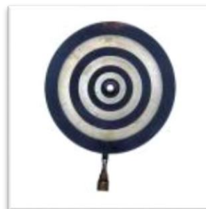
Figura 2.4. Disco di Placido. Il disco era in ottone mentre il manico in legno (Eye Antiques & Collectibles: http://eyeantiques.com/products-page/eye-exam-equipment/placido-disk/ ).
